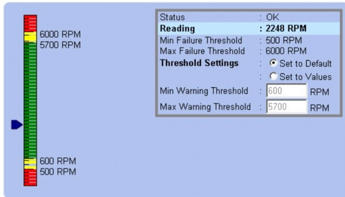
図 5-2 ゲージインジケータ
